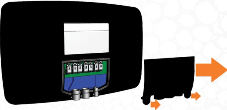
2. Dénudez le câble personnalisé de 0,25 pouce (6,5 mm) (il est recommandé d'étamer le fil torsadé). Faites glisser le câble à travers l'ouverture du joint pour le jeu de bornes correspondant.
